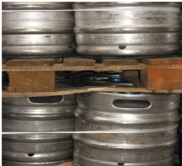
zdj. 3. Uszkodzona paleta albo na skutek przeciążenia lub przez złe ułożenie na wystającym kołnierzu beczki, która jest niepoprawnie włożona na innej beczce.
