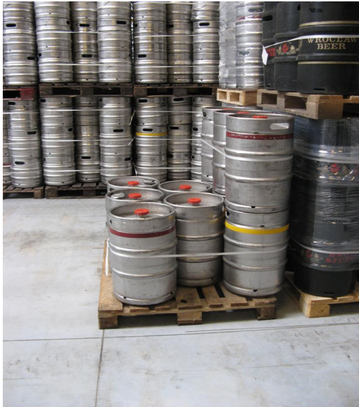
zdj. 5. Zabezpieczona dolna warstwa beczek taśmą jak i trzy beczki (takie zapotrzebowanie – zamówienie), w takiej formie pił KEG jest wysyłane do klienta.
