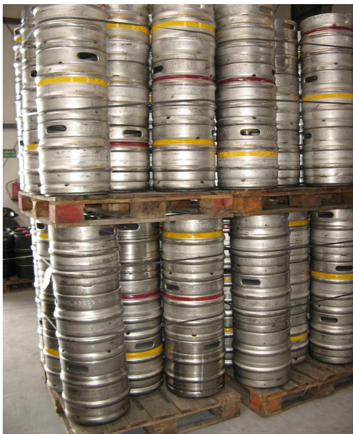
zdj. 6. Trzy warstwy beczek zabezpieczone tylko dwoma taśmami i to nie równomiernie.
